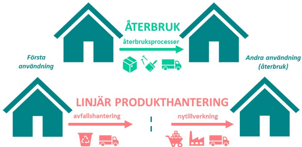
Figur 10. I konsekvens-LCA utvärderas återbrukets klimateffekter genom att jämföra återbruk med den linjära produkthantering återbruket antas ersätta.
